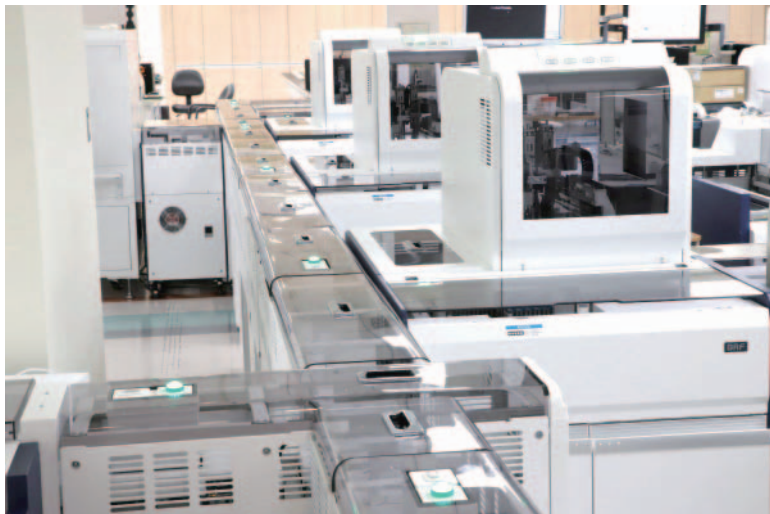
▲桃園長庚「全自動智能檢驗室」引進「雙層雙向四軌設計的高效能自動軌道系統」
