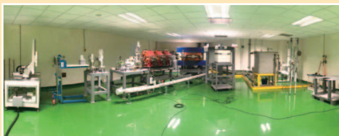
▲林口長庚粒子物理暨照射核心實驗室模擬太空環境，協助國研院太空中心執行太空電子元件之抗輻射測試，進一步提升台灣電子產業邁向航太電子產業發展
